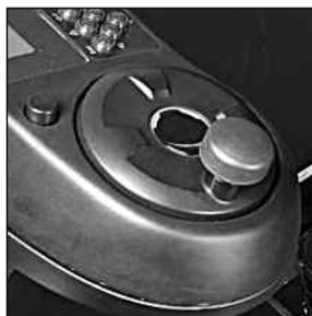
Direction électronique « Fly-by-wire »
